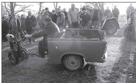
A versenyben induló járművek közül a kedvencem Szalai János Őszvér nevű csettegője. Alkatrészei: Trabant kombi hátsó, ILO motor, Fiat 500, Trabant kerék.
