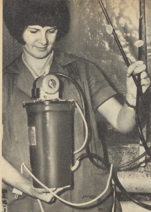
Szivattyú-motorral felszerelt szűrővödör (külső filtráló), a vízleszívó- és a szűrt vizet visszavezető csőkábelekkel
