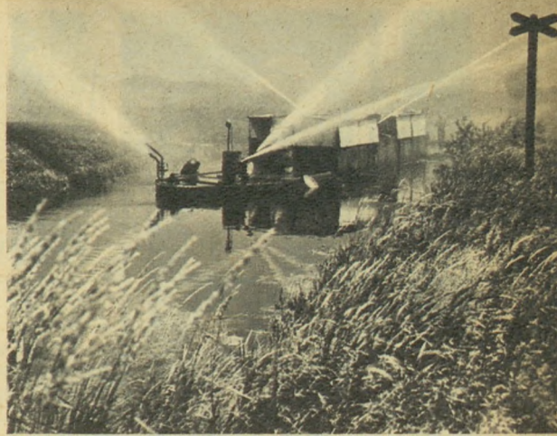
Az élelmiszerek bőségeért! Öntözőhajó „esőágyú” szórják az öntözővizet a balatonagyebereki állami gazdaság szántóföldjére
