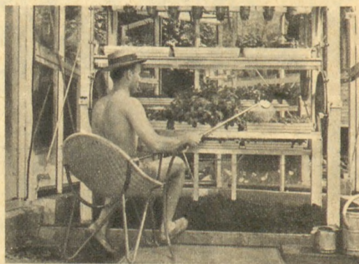
A 7/4/G típusú toronyüvegház kezelőhelyisége, ahol egyetlen munkás kényelmesen láthatja el egy 64 m felületű és kb. 18 m magas szalagrendszer növényeinek gondozását (permetezést, tápanyagellátását). A paternoster-szerű szalagrendszer legalsó vízszintes átfutásán kerülnek a növények a kertész elé, aki a szükséges gondozási műveleteket elvégzi a folyamatosan tovagördülő növényeken
