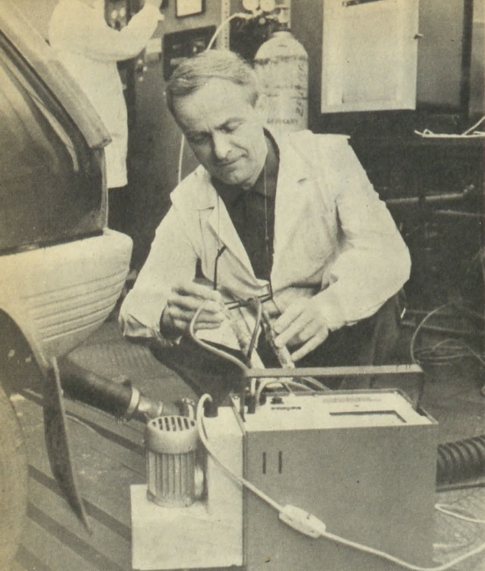
A Berlin—Adlershof-i Kipufogógáz Ellenőrző és Kutató Állomáson az intézet vezetője, dr. Edmond Hüningen (az előtérben) egy gépkocsi üresjáratú motorjának felfogott kipufogógázából a szén-monoxid-mennyiséget állapítja meg
