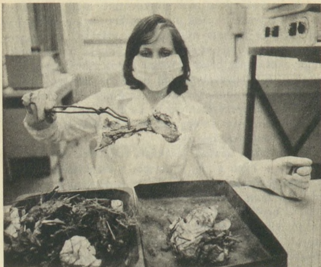
A Közterület Fenntartó Vállalat laboratóriumaiban folyamatosan elemzik a háztartási szemét összetételét. Képkön: a mintát égetési próbára készítik elő. (MTI Fotó — Bara István felvétele)
