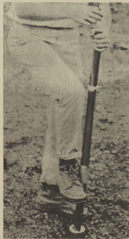
Az ültetőpuska földbeszúrása után a facsemetét a csöbe helyezik és lábpedál lenyomásával juttatják a földre
