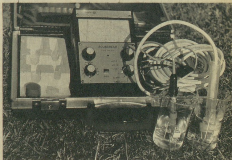
Ez a hordozható elektronikus műszer a vizek oxigéntartalmának gyors meghatározására szolgál
