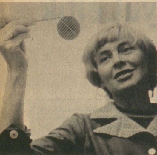
Ez a napelem-cella szilíciumból készült
