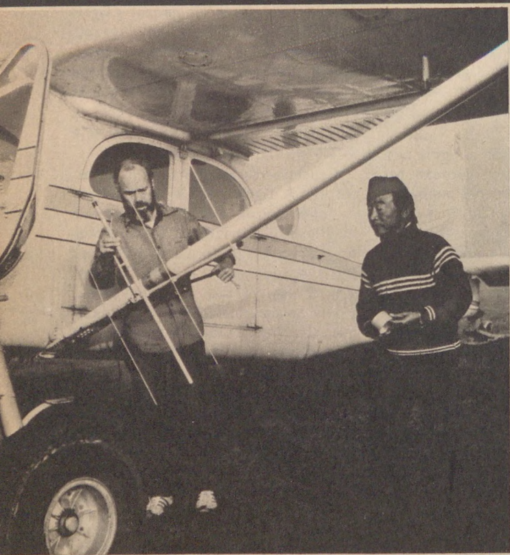
A felderítő repülőgépre a rádiójeleket vevő antennákat erősítenek
