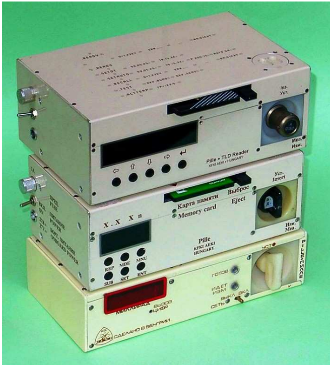
1. ábra. Pille készülékek. A felső készülék az ISS-en, a középső a Mir űrállomáson használt készülék, az alsó a Farkas Bertalan által használt változat
