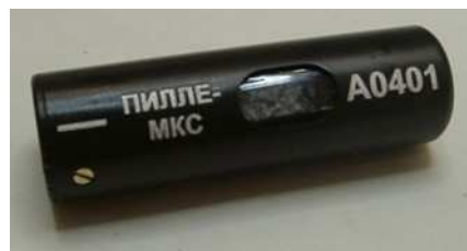
15. ábra. Az űrséta dózismérők kiolvasására szolgáló dózismérő tartó és az abba helyezhető dózismérő patron
