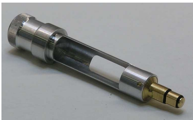
15. ábra. Az űrséta dózismérők kiolvasására szolgáló dózismérő tartó és az abba helyezhető dózismérő patron
