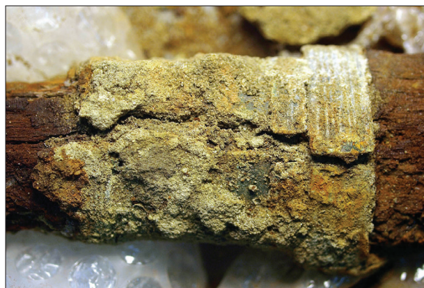
3. kép Korrozíós termékek halmaza és a korrózió által eltávolodott illesztések Fig. 3 Rust and once attaching surfaces separated by corrosion
