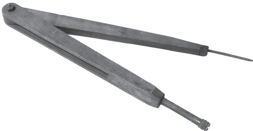
2. kép. A BMI.74.294 leltári számú körző, amelyet a párnák és terítők körformáinak az anyagon történő könnyebb kiszekerzéséhez használtak.
