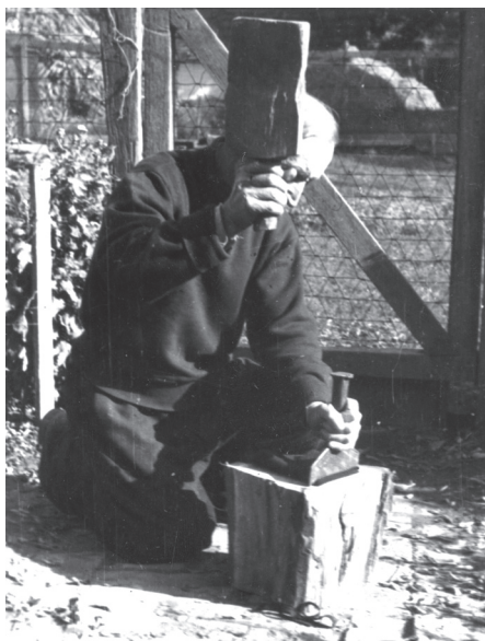
1. kép. Mezei András szélcakkozás közben. Eszközei: tőke, szélcakkozó és fakalapács. (Biahri Múzeum adattára Ad/VIII.1018-99.)
