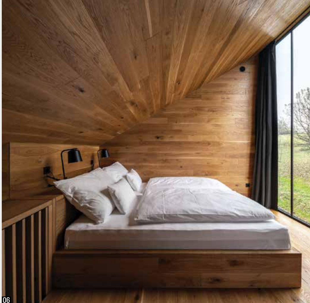
06 A hálószoba egyetlen térömlenyként kapcsolódik a balra lenn elhagyott nappali teréhez. A fűtést itt is a nyílászárók oldják meg, a hűtést a kép bal oldalán látható lamellás fabútorba rejtették
