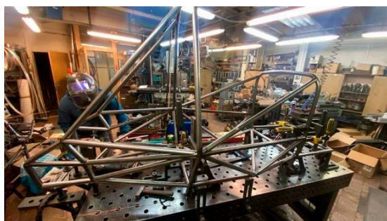
8. ábra Legyártott csőváz
