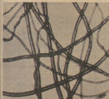
Lágy szálú szűrőanyag (perlonvatta) mikroszkópos képe
