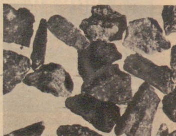
Bazalt-zúzalék (az akváiumi előszűrő töltetéhez alkalmas szemcseméret)
