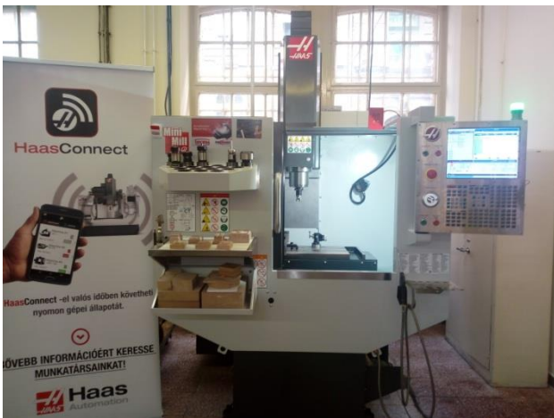
4. ábra: Haas MiniMill Edu CNC marógép
