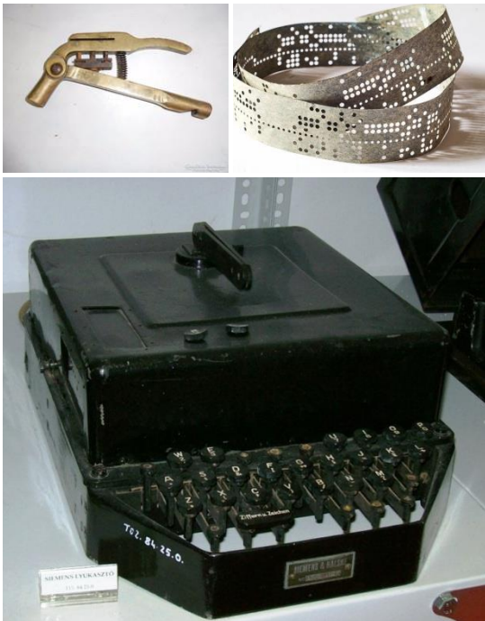
1. ábra: Kalauz lyukasztó, lyukszalag és lyukasztó írógép [1][2][3]
