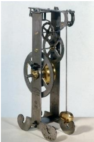
11. ábra Galilei féle leírás alapján elkészített középkori ingamodell replikája
