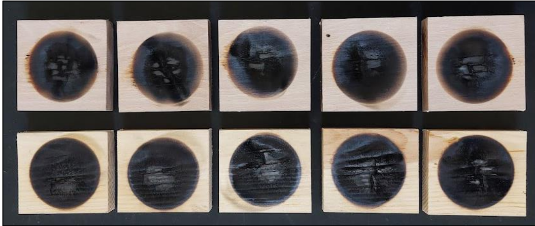
2. ábra: Fa minták Lindner módszeres beégés vizsgálatot követően (készítették a szerzők)
