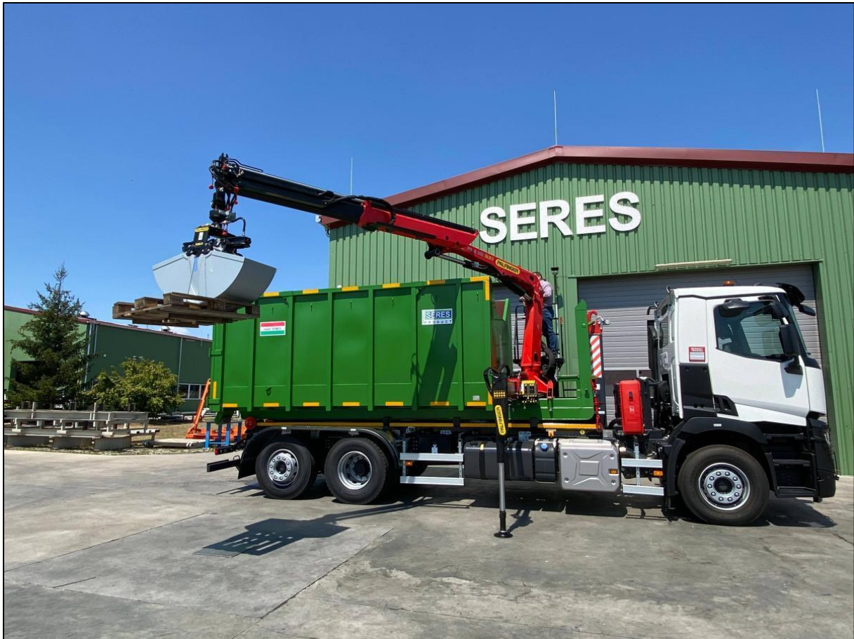
23. ábra: Illusztráció daruval rendelkező konténerszállítóról (Forrás: ld. [18])
