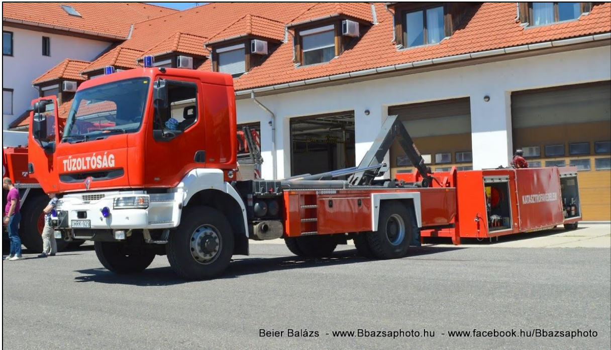
24. ábra Tűzoltóság által használt cserefelépítményes hordozójármű (Forrás: ld. [19])
