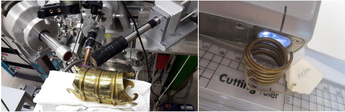
4. ábra: Bronzkori arany karpánt PIXE és hajkarika pXRF mérése (fotó: Kertész Zsófia, Maróti Boglárka).
