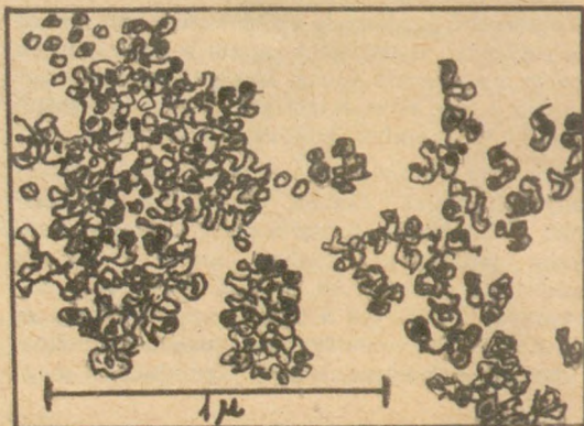
1. ábra. Agyagásványoktól kevésbé és jobban megtisztított huminsavak elektronmikroszkópos képeinek vázlata Beutelspacher nyomán 3,8 pH-nál. A bal oldali ábrán jól látható az agyagásványok szennyező hatásaként a lemez szerkezet, míg az agyagásványoktól jobban megtisztított huminsavak a jobb oldali ábrán láthatóan globuláris kolloidokként szemcsésen csapódnak ki, mintegy koacervátumszerűen
