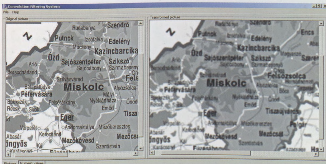
Jobb oldalon az 5x5 pontos aluláteresztő szűrővel élsimított kép látható, a bal oldalon pedig az eredeti
