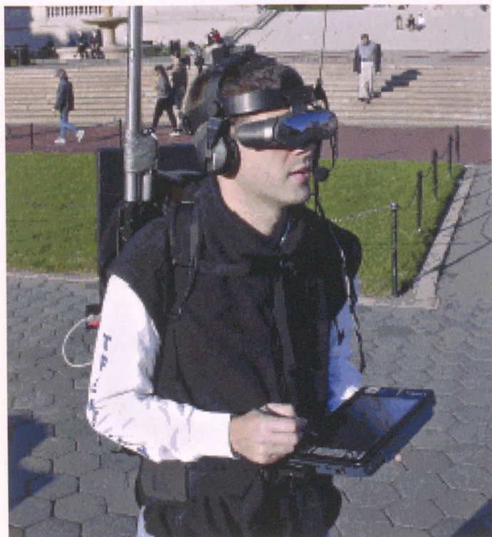
1. ábra – A felhasználó a „Mobil megnövelt valóság rendszert” viselve, hátán az ehhez szükséges számítógéppel, valós idejű, kinematikus GPS-szel, szemüvegbe szerelt kijelzővel és inerciális tájolóval, valamint a kéziszámtógéppel
