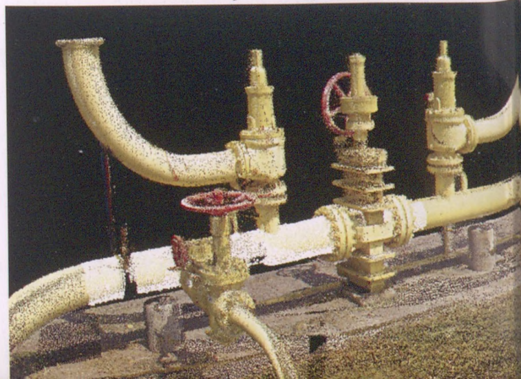
2. ábra – Henger illesztése pontfelhőre
