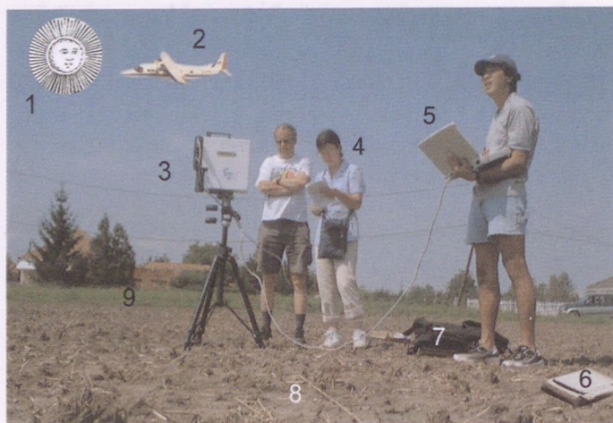
Egy komplex hiperspektrális távérzékelési rendszer működés közben. 1. Nap (csak teljes napsütésben lehet mérni); 2. A DLR Dornier 228 repülőgépe, rajta a DAIS és ROSIS képalkotó spektrométerek; 3. GER 3700 terepi spektorradiométer; 4. Jegyzőkönyv készítése a terepről; 5. Hordozható számítógép az adatok rögzítéséhez; 6. Fehér referencia tábla a beeső napsugárzás meghatározására; 7. GPS (kb. 10 m pontosságú helymeghatározásra); 8. Talaj; 9. Növényzet.
