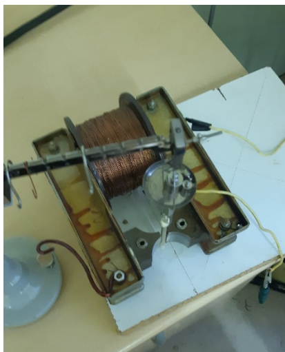
1. ábra. Az elektromágnes nagy indukciójú részének kialakítása
