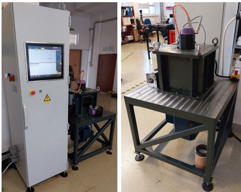
7. ábra. Elkészült és beüzemelt motor fékpad
