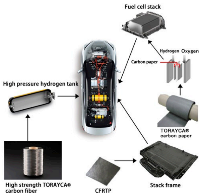
14. ábra. A Toyota Mirai hibrid meghajtású jármű előállításához felhasznált kompozitok. [12]
