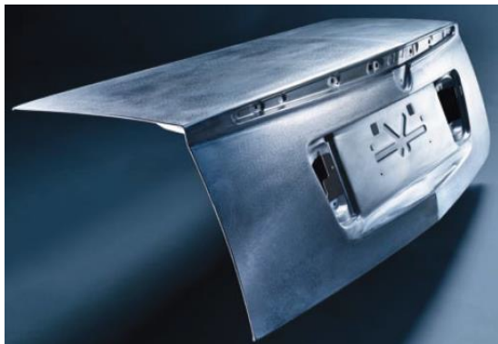
12. ábra. Cadillac STS gépjármű TopForm® SPF minőségű alumíniumötvözetből szuperképlékeny alakítással gyártott csomagtér ajtaja. [14]
