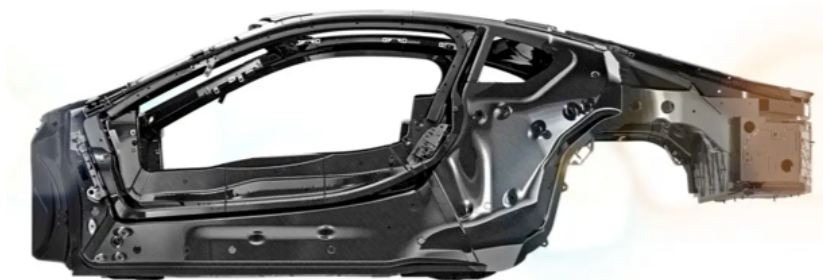
4. ábra. A BMW i8 hibrid gépjármű karbon karosszériája. [5]
