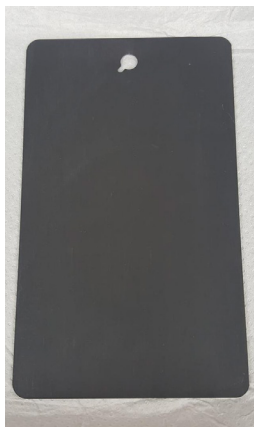
4. kép. Magán-foszfátózott Q-panel megjelenése.
