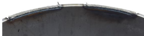
14. ábra: 10. számú minta (varratkép a belső oldalon)
