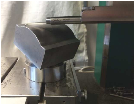
19. ábra: Szabad formájú felület mérés
