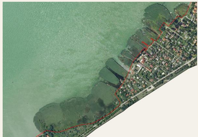
14.kép: 2008. évi ortofotó-kivágat Balatonföldvár-Szántód határán lévő parti sávról. A piros vonal a jogi partvonalat reprezentálja (m.a. 1: ~4000, a növényzet két végpontja közötti távolság kb. 1100 m, legnagyobb szélesség kb. 180 m)
