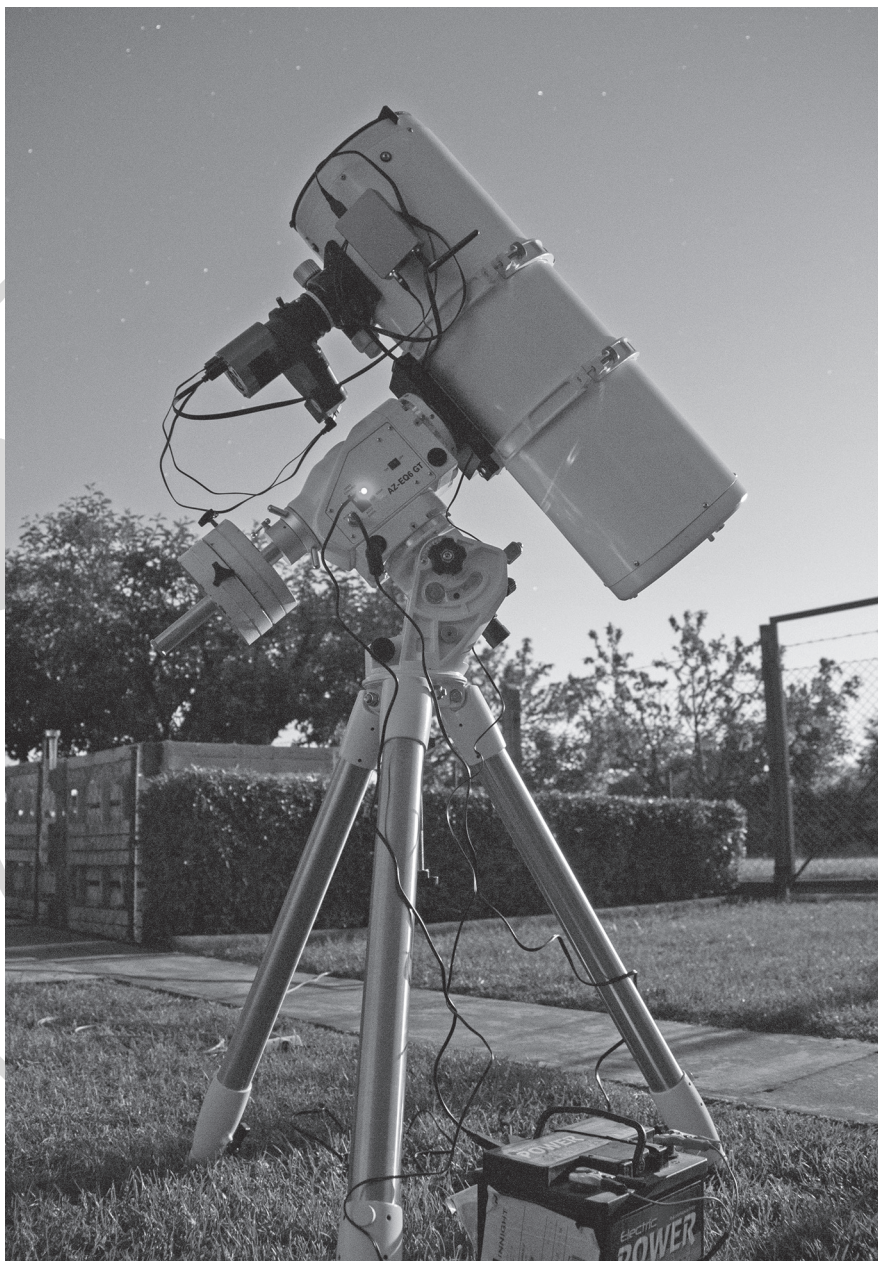
SkyWatcher AZ-EQ6 mechanika, Lacerta 200/800 Newton, ASI1600 és ASI1600 kamera
