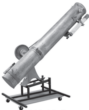
Tombaugh 1927 körül készült Newton-távcsöve azimutális mechanikán (historical.ha.ca)
