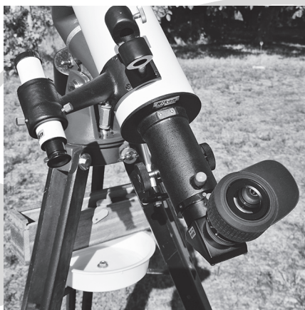
A Nikon-refraktor 1,25"-os Baader-zenitprizmával (Lőrincz Imre felvétele)
