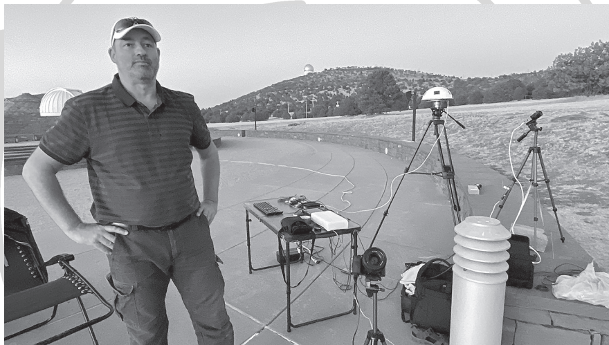
Igaz Antal a három meteorkamerával. Előtérben a 35x55 fokalátótávolságú 8–8,5 magnitúdós határfényességű videók rögzítésére képes Sony A7S kamera, jobb szélén a tűzgömbvadász mini kamera, hátul pedig az AllSky7 teljeségbolt-kamera. (Fotó: Rózsahegyi Márton)
