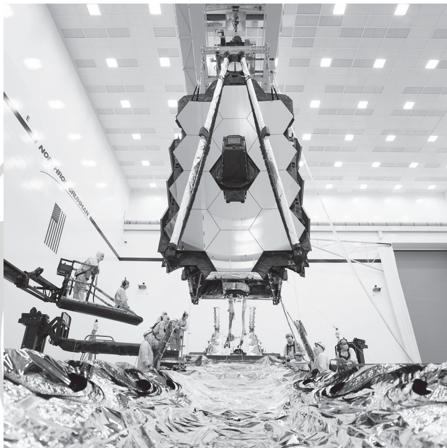
A James Webb-űrtéleszkóp főtükre három részre hajtható össze. A képen kétoldalt becsukott állapotban láthatjuk (fotó NASA)
