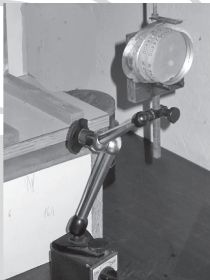
A próbapad nálam egy mágnes talpas mérőóra állvány. Az ellipszis sík és a hátoldal között két buborék segítethető
