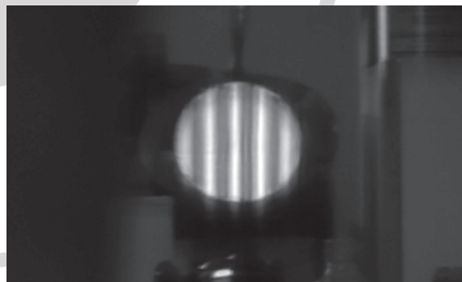
Majdnem kész, csillagpróbára váró hiperboloid víz immerzióval
