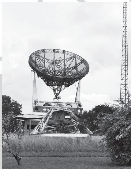
A II. világháborúból, az 1940-es évekből fennmaradt Würzburg típusú radarantennát rádiótávcsővé alakították át (Mönich László felvétele)
