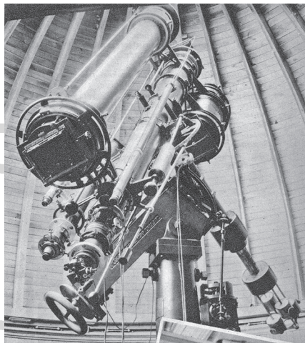
1927-ben épült meg a második 5 méteres kupola, amelyben a megszűnt kiskertali csillagvizsgáló 18 cm-es Merz-Cooke-refraktora kapott helyet
