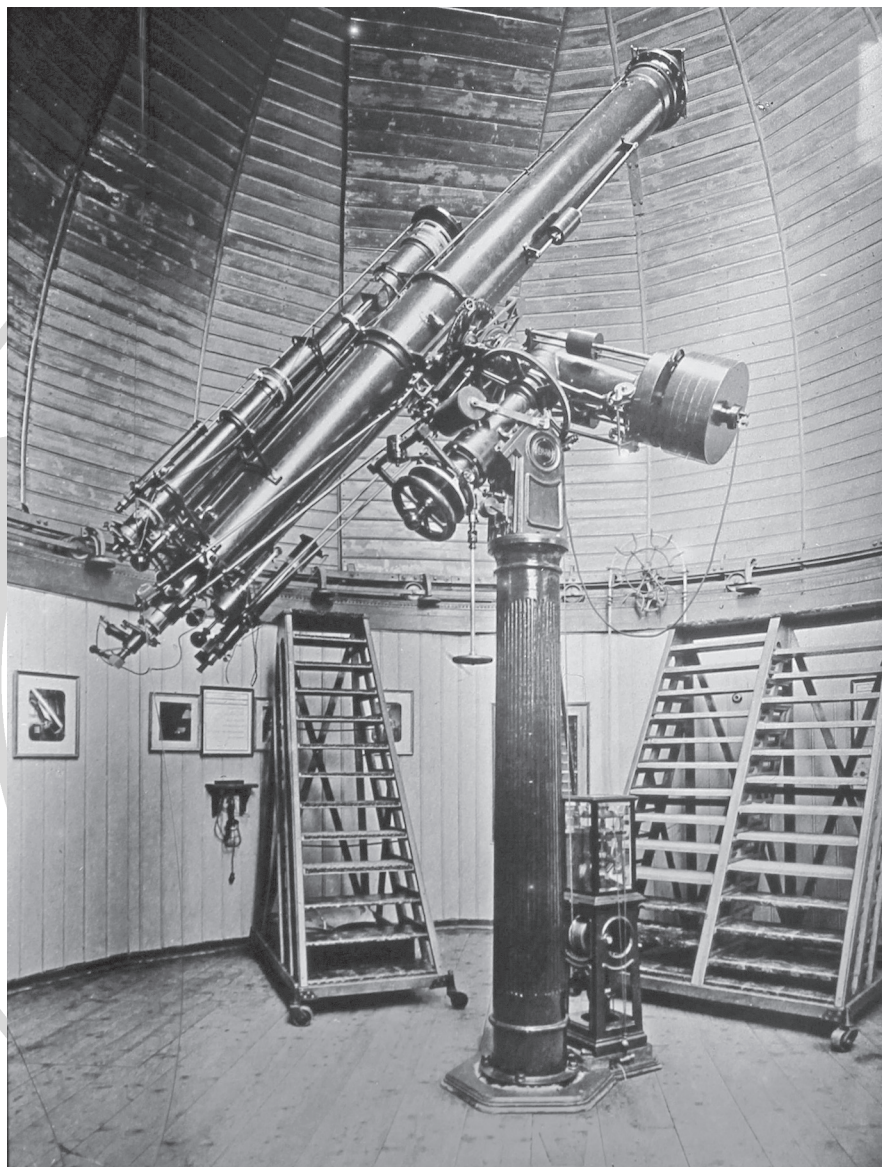
A 25 cm-es refraktor a z 1905-ös átépítés után. A sok ponton módosított és korszerűsített távcsőre egy 160 mm nyílású asztrográf került. További szembetűnő változás, hogy a súlyhajtású óragépet a tengelykereszt alatti „kápolnából” a távcsőoszlop tövébe helyezték át. Az átalakítás után már Merz-Zeiss-Konkoly-refraktorként hivatkozik rá Konkoly Thege Miklós. A műszerfelújításról az 1906-ban megjelent, igen részletes, „Adalékok a 252 m /m refractor, egy theodolit és egy chronograph átépítéséhez” című munkájában olvashatunk. (fotó: CSFK Csillagászati Intézete)
