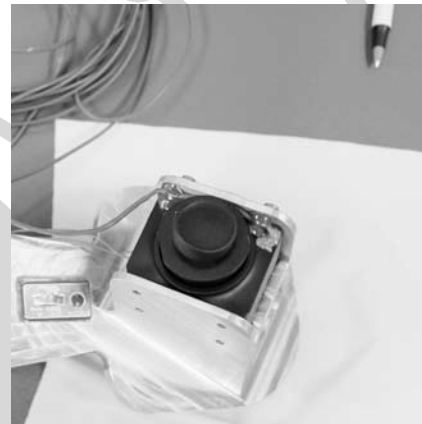
A SCALPSS kamera vákuumkamerában történő tesztelése előtt. Méretét a képen látható ceruzahegy is szemlélteti (NASA)
