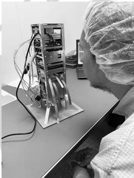
Pál András épp a VZLUSAT-2 proto-flight modelljéhez próbálja kitalálni, hogy a rövid kábeleket hogyan lehet megtoldani (Werner Norbert felvétele)
