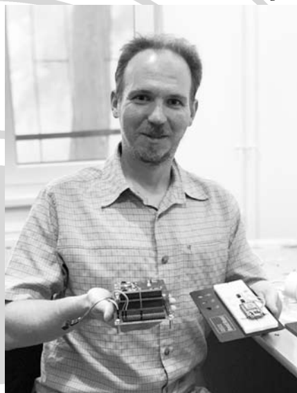
Interjúalanyunk bal kezében a GRBAlpha kisműholdon repülő gammadetektor-elektronika protípusa, jobb kezében belső kommunikációs modulokat tesztelő berendezés (Kiss L. felvétele)
