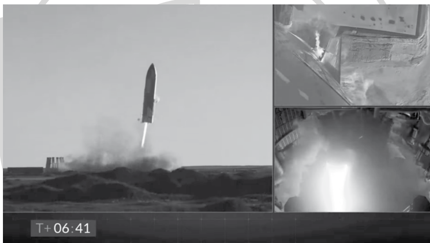
Az SN8 néhány másodperccel a robbanás előtt. Láthatóan csak az egyik fúvóka dolgozik, melynek tolóereje nem volt elégséges a fékezéshez (Youtube/SpaceX)
