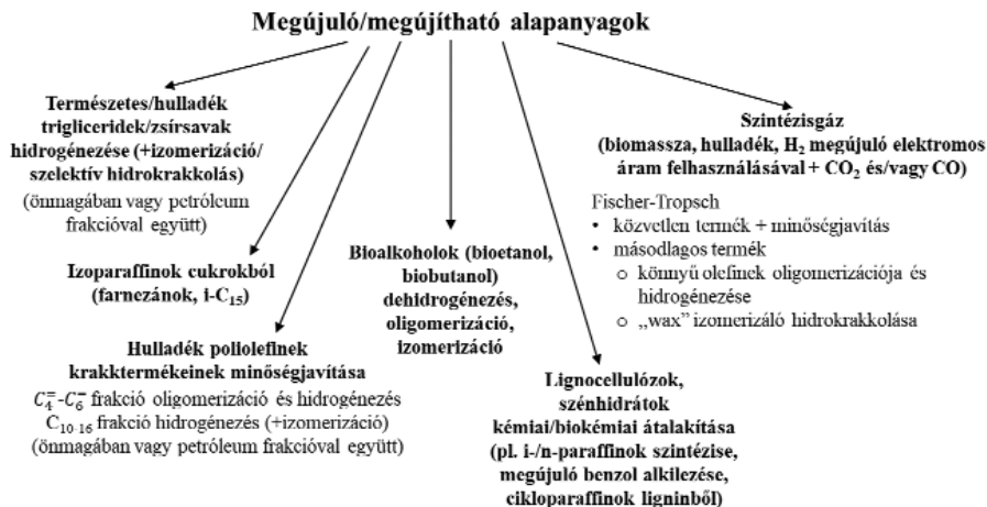
1. ábra. Sugárhajtómű-üzemanyagok (JET) főbb előállítási lehetőségei megújuló/hulladékforrásokból (példák)
