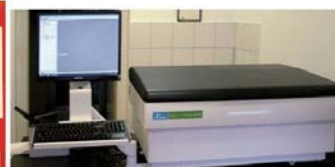
folyadékcintillációs spektrométer a szén radioaktivitásának mérésére
