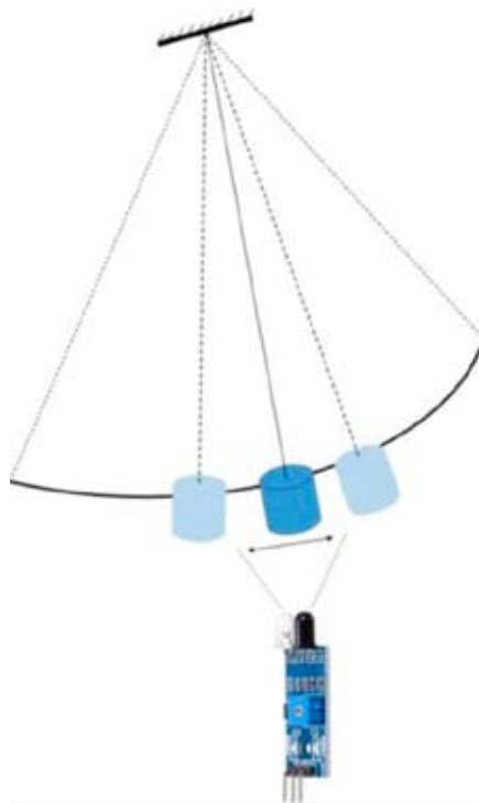
7. ábra: A mérés technikai ábrája IR akadályelkerülő szenzorral
