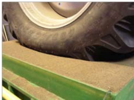
8. ábra: A gumiabroncs-vizsgálat és az abroncs talajlenyomata
