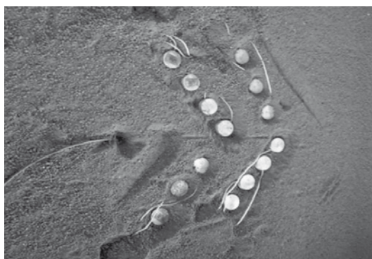
7. ábra: A szenzorok elhelyezése a gumiabroncs alatt
