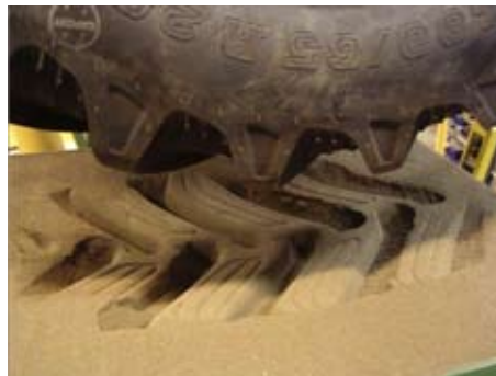
8. ábra: A gumiabroncs-vizsgálat és az abroncs talajlenyomata
