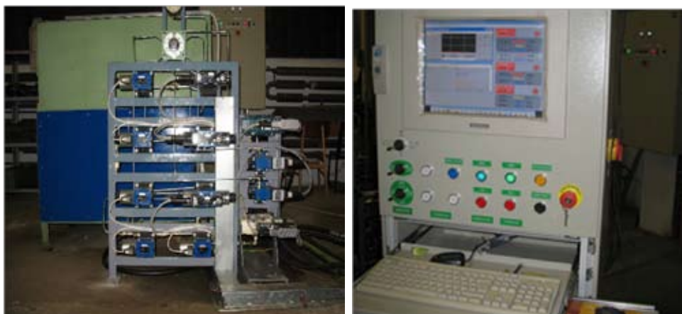
2. ábra: A Danhauser gép elektrohidraulikus vezérlése
