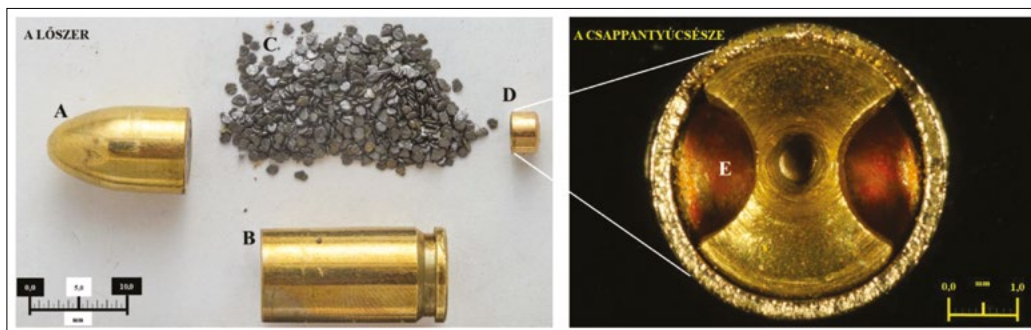
1. ábra. Az NSZKK (Nemzeti Szakértői és Kutató Központ) fegyverszakértői laboratóriumában hatástalanított (elműködött) és szétszerelt 9 mm kaliberű lőszer részei balról jobbra. A. a rézköpenyes, ólommagos lövedék; B. a lőszerhüvely; C. a lőszerhüvelyben található löportöltet, D. a lőszerhüvely alsó részéből eltávolított és a gyúelegyet tartalmazó csappantyúcsésze, E. a csappantyúcsésze lőszerhüvely felőli, fotomakroszkóppal készült képe a belső felületére felhordott gyúeleggyel (Forrás: Ujvári Zsolt fényképfelvétele)
