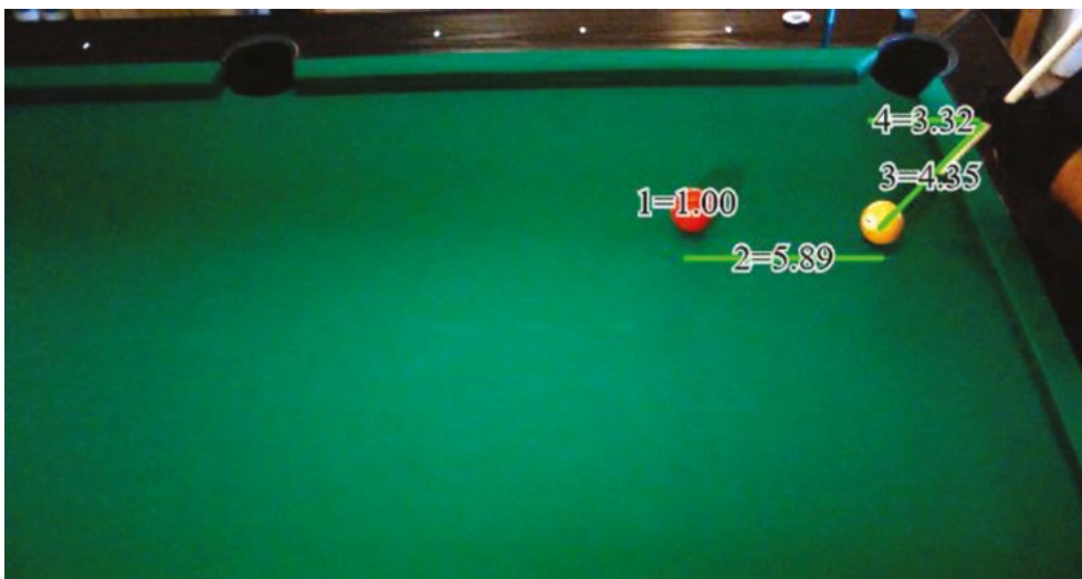
5. ábra. A képen lévő távolságok méretezésére a [2] online programot használtuk. A kalibráláshoz a piros golyó átmérőjét (6 cm), 1-nek választottuk. Így a két golyó tömegközéppontja ( x_1 ) 35,34 cm távolságra van. A dákón jelölt átfogó 26,1 cm, a jelölt vízszintes befogó 19,92 cm. Ezek alapján a a dákó vízszintessel bezárt szöge: kb. 40 fok
