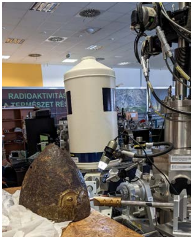
1. ábra. A Nyemija-sisak vizsgálata az ATOMKI Tandetron Laboratóriumban kihozott nyalábos mikro-PIXE módszerrel (PIXE: részecskeindukált röntgenemisszió)
