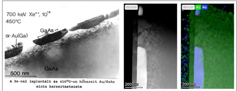
4. ábra. Egy világos látóterű TEM-kép a régi cikkből, középen az új mikroszkóppal készült HAADF STEM-kép Z kontraszttal, jobbra az egyes elem térképekből az arzén és az arany eloszlása egy képpen
