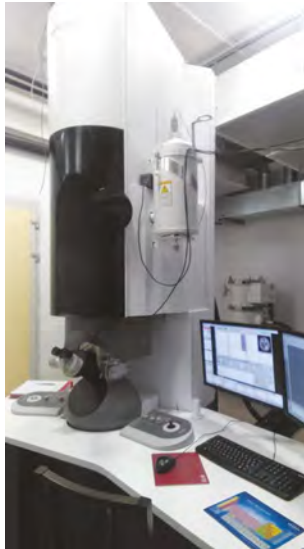
3. ábra. A THEMIS 200 képkorrigált mikroszkóp az EK MFA laborjában, ahol az elhelyezés megkövetelt műszaki paramétereit rezgésmentes alap, 30 nT-ra csökkentett szórt 50 Hz-es mágneses tér és rendkívüli hőmérséklet-stabilitás biztosítja (az oszlop mellett fél óránként 0,1 °C-ot változhat maximum a hőmérséklet)
