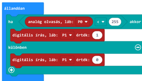
37. ábra: A fotocellás lámpa programja
