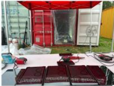
Kísérleti helyszín propán-bután gázpalackról működő kerámiabetétes hőszugárzó szén-dioxid, és szén-monoxid fejlesztés rekonstrukciós munkák végrehajtásához Forrás: BM OKF, Országos Tűzmegeelőzési Bizottság
