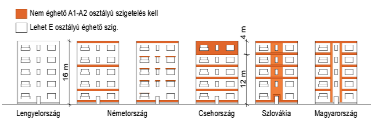
3. ábra: Kőzetgyapot sávok kialakításának követelményei európai országokban (forrás: szerzők összeállítása [12] alapján)
